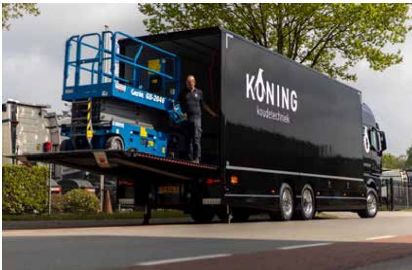
Steunpootjes uit, de hoogwerker wordt gelost.
